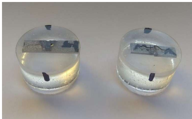
Figura 3.47-Amostras embutidas para os ensaios de dureza
