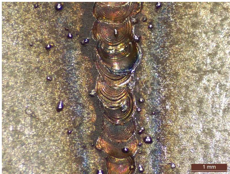
Figura 4.7-Foto da raiz de soldadura da amostra 4. Ampliação 16× no estereomicroscópio Leica EZ4W
