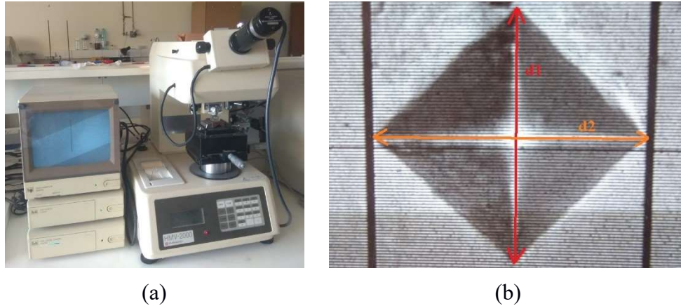
Figura 3.51-(a) Máquina Shimadzu HMV 2000. (b) Indentação de Vickers
