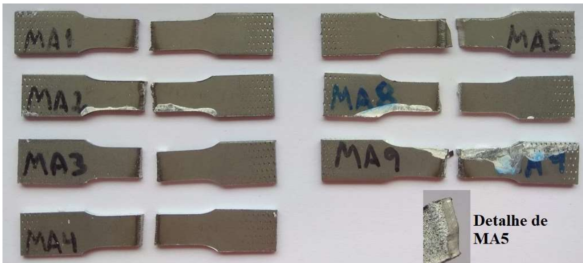
Figura 4.13- Provetes MA1, MA2, MA3, MA4, MA5, MA8 e MA9 após a tração na Shimadzu 100 kN utilizando o Aramis
