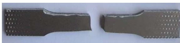
Figura 4.1-Provete de material base tracionado até à rotura
