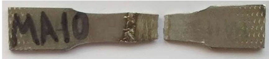
Figura 4.15-Provete MA10 após o ensaio na Shimadzu de 100 kN
