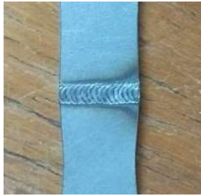
Figura 3.38-Deformação não uniforme na região soldada
