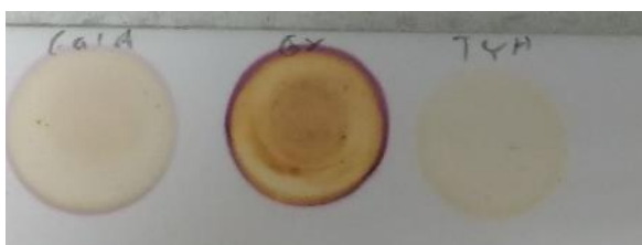
Kuva 1 Orsinoliliuksen testaukset. Vasemmalla GalA-standardin, keskellä GX-standardin ja oikealla veden kanssa reagoineet orsinoliliukset 10 min 100 °C:ssa jälkeen.
