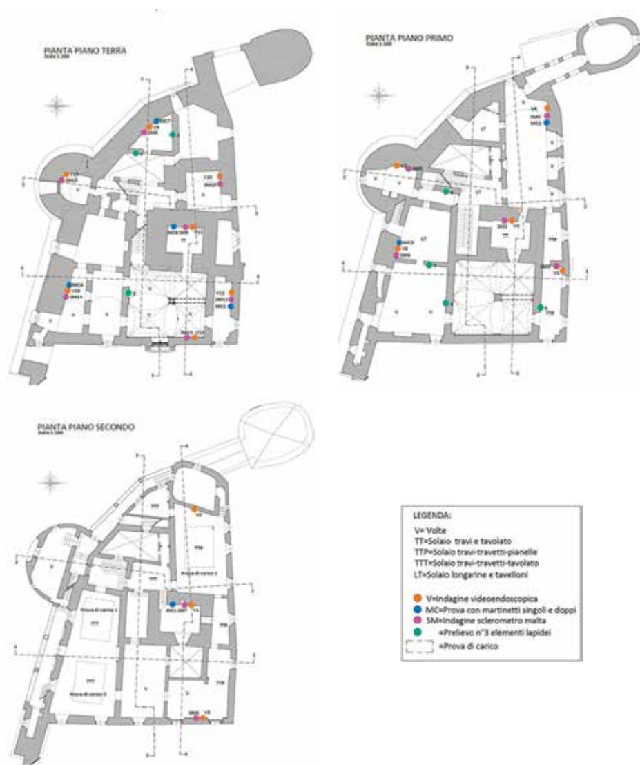
Fig. 7. Localizzazione aree di prova piano terra.
