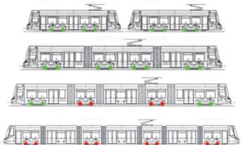
Figura 3. Possibili configurazioni di tram Skoda con quattro carrelli. Il colore verde indica i carrelli pivotanti, mentre il rosso indica quelli non pivotanti.
