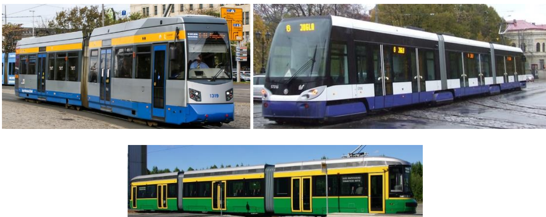
Figura 12. In senso antiorario: tram a due unità Leoliner, tram a tre unità Forcity Alfa con carrelli Jakobs, tram a tre unità Artic
