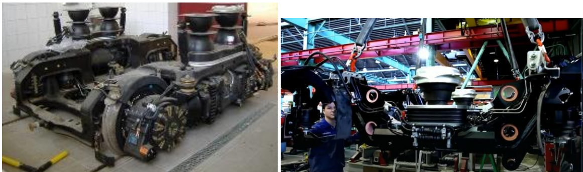
Figura 9. Carrelli non pivotanti con sospensioni secondarie in gomma, del Combino Supra a sinistra e dell' Avenio a destra (il motore longitudinale esterno non è presente)
