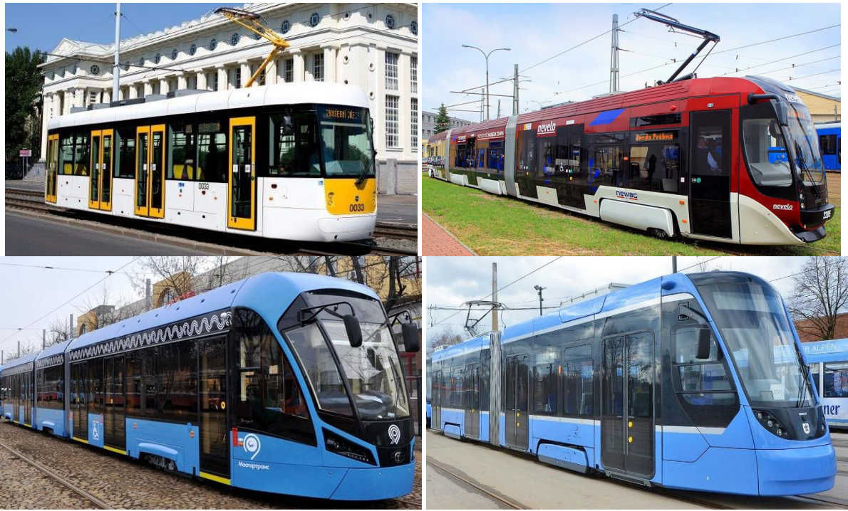
Figura 8. In senso antiorario: tram a unità singola EVO1, tram a tre moduli Nevelo, tram a tre moduli con carrozino centrale Vityaz-M, tram Avenio a due moduli
