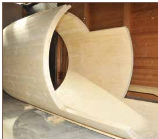
Esempio di una realizzazione a forma cilindrica, con un raggio di curvatura minimo, composta per parti.
