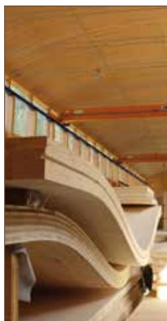
Componenti di XLAM prefabbricati, con raggi di curvatura variabili. Stoccati nello stabilimento di produzione, sono pronti per la spedizione in cantiere.
