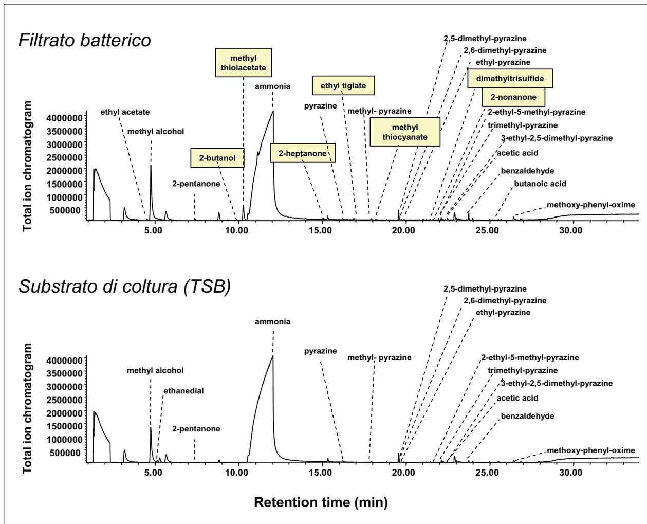
Fig. 4 – Cromatogrammi delle sostanze volatili identificate nello spazio di testa del filtrato di *P. putida* e del substrato di crescita (TSB). Sono evidenziati i composti derivanti dal metabolismo batterico.
