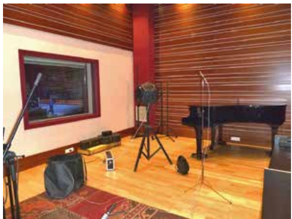
Fig. 4 - La Sala A (stanza emittente) con la sorgente dodecaedrica omnidirezionale e il microfono per il rilevamento della pressione sonora dell'ambiente emittente
