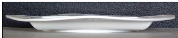
Fig. 4. Bending of the rim.
