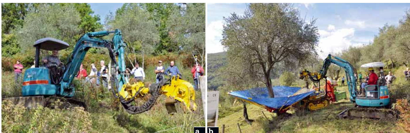
Foto 7 Scuotitore applicato a un escavatore (a) e cantiere con ombrello per il recupero delle olive (b)
