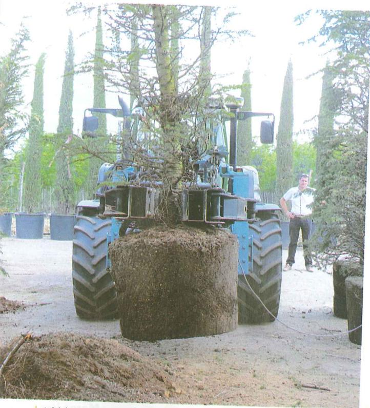
Iniziale prototipo sviluppato in fase di lavoro: recupero vaso - presa - scuotitura - separazione biomassa da terriccio
