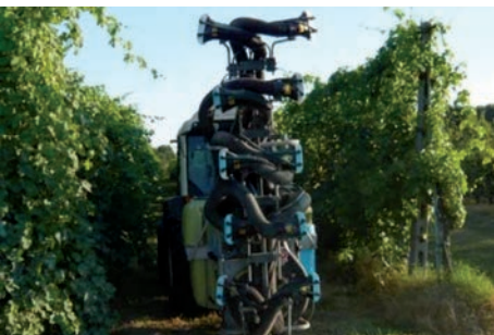
irroratrice con applicazione della carica elettrostatica
