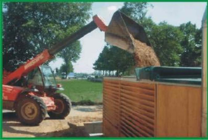
**Modalità di riempimento del silo di stoccaggio**
