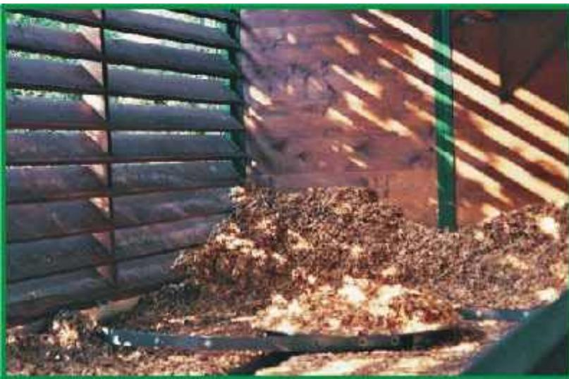
**Rotore singolo per estrazione del cippato**
