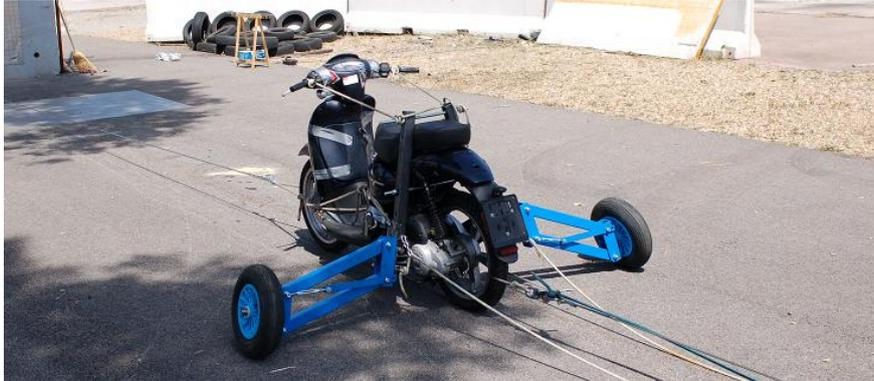
Figura 3: Scooter equipaggiato con le ruotine posteriori e collegato anteriormente all'elastico di traino. Sullo sfondo la barriera rigida inamovibile, costituita da un blocco di cemento di massa pari a 44000kg.
