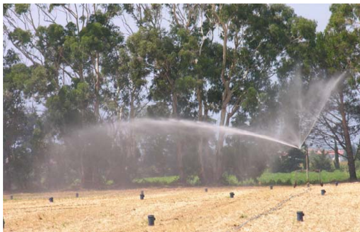
Figura 1. Rilievo dell'uniformità in campo su rotolone.
