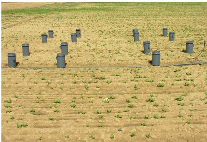
Figura 3. Allestimento della prova di uniformità su impianto a pioggia con microirrigatori.
