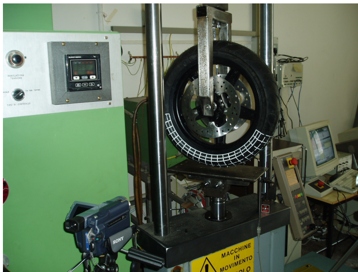
Figura 4 Prova di compressione per il pneumatico anteriore
