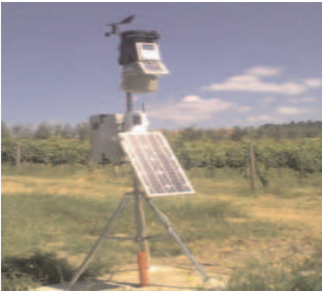
Fig. 13 - Moderna centralina meteorologica installata presso un'azienda del comprensorio del Chianti Classico Fig. 13 - Modern meteorological unit installed in the area of Chianti Classico.
