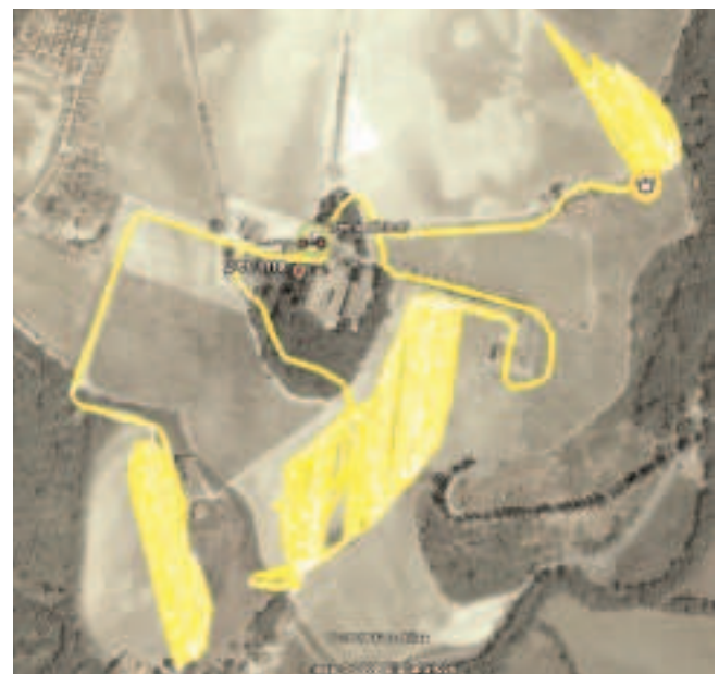
Fig. 20 - Visualizzazione in tempo reale del lavoro di una macchina vendemmiatrice durante le prove di telemetria (Deistaf - Claas, 2009). Fig. 20 - Real time working view of a grapes harvester during the telemetry test (Deistaf - Claas, 2009).
