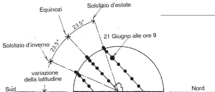
6.11 sezione della vista est della finestra solare
