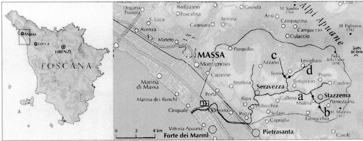
Fig. 1. Versilia river basin and streams analyzed: (a) Canale delle Mulina; (b) Fosso di Pomeziana; (c) Canale del Giardino; and (d) Canale del Bosco. Position of slit-check dams is identified by black dots (right map).
