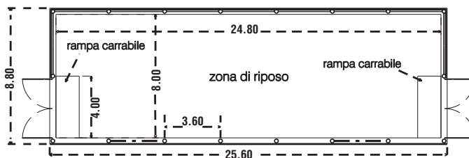
E) Stalla a stabulazione libera a lettiera permanente, con zona di alimentazione separata
