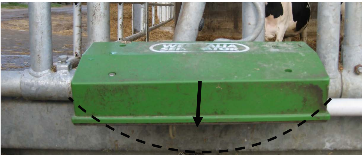
Abbildung 21: Tiererkennungseinheit, Ausrichtung des Felds vom Fressgitter weg gerichtet
