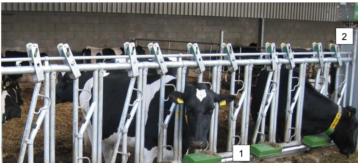
Abbildung 17: Fressplätze im Stall mit Tiererkennungseinheit (1) und Prozesscomputer (2)
