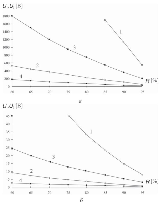
Рис. 2. Зависимости величин управляющего напряжения амплитудного модулятора Фабри–Перо от коэффициента отражения зеркал для заданного отношения сигнал/фон, равного 50, при температуре  $20\text{ }^\circ\text{C}$  (а),  $-55\text{ }^\circ\text{C}$  (б) в случае однократного ( $U_1 - 1, 2$ ) и двукратного ( $U_2 - 3, 4$ ) прохождения его световым пучком
