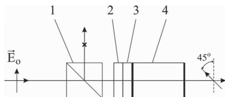
Рис. 3. Оптическая схема амплитудного модулятора Фабри–Перо с поляризационной фильтрацией
