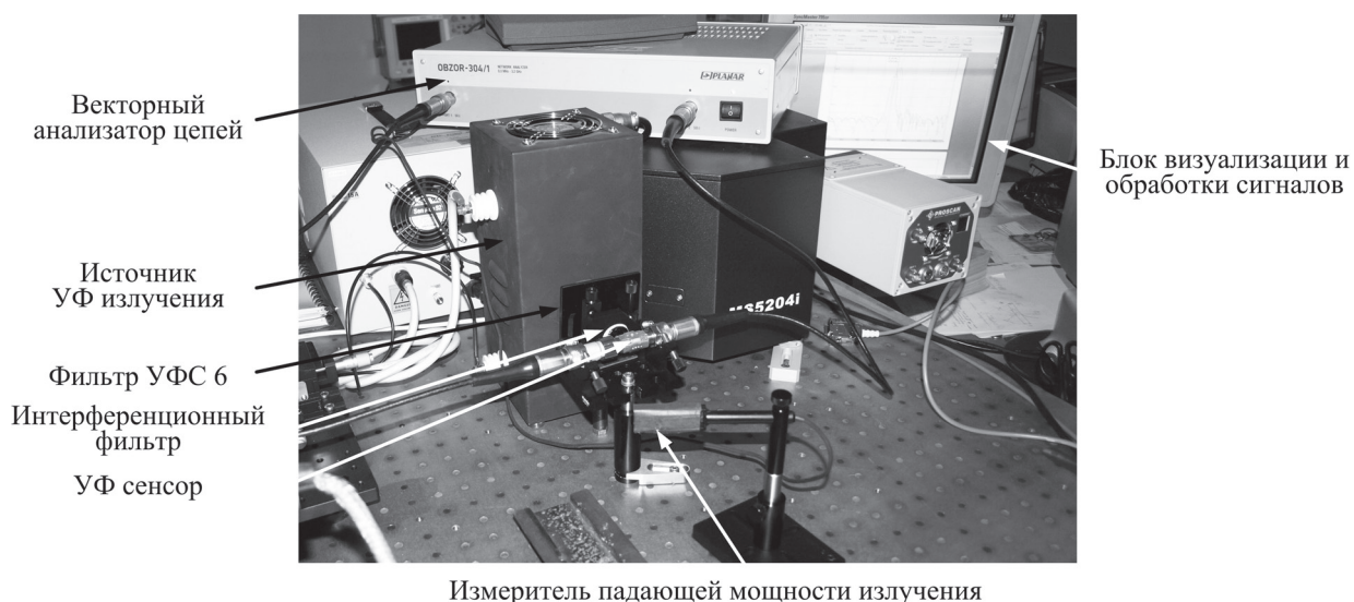
Рис. 2. Измерительная установка для исследования УФ сенсоров на ПАВ
