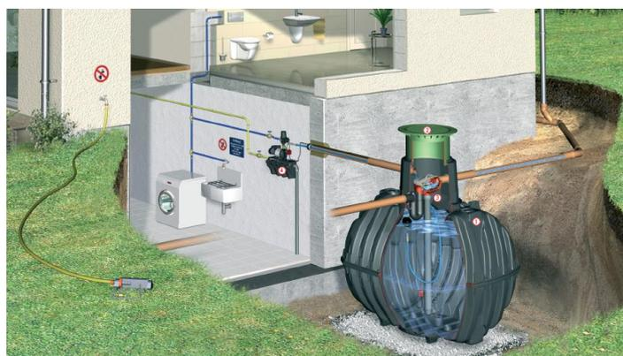
Figura III.17 - Imagem virtual do reservatório (Manual técnico da GRAF, 2009)
