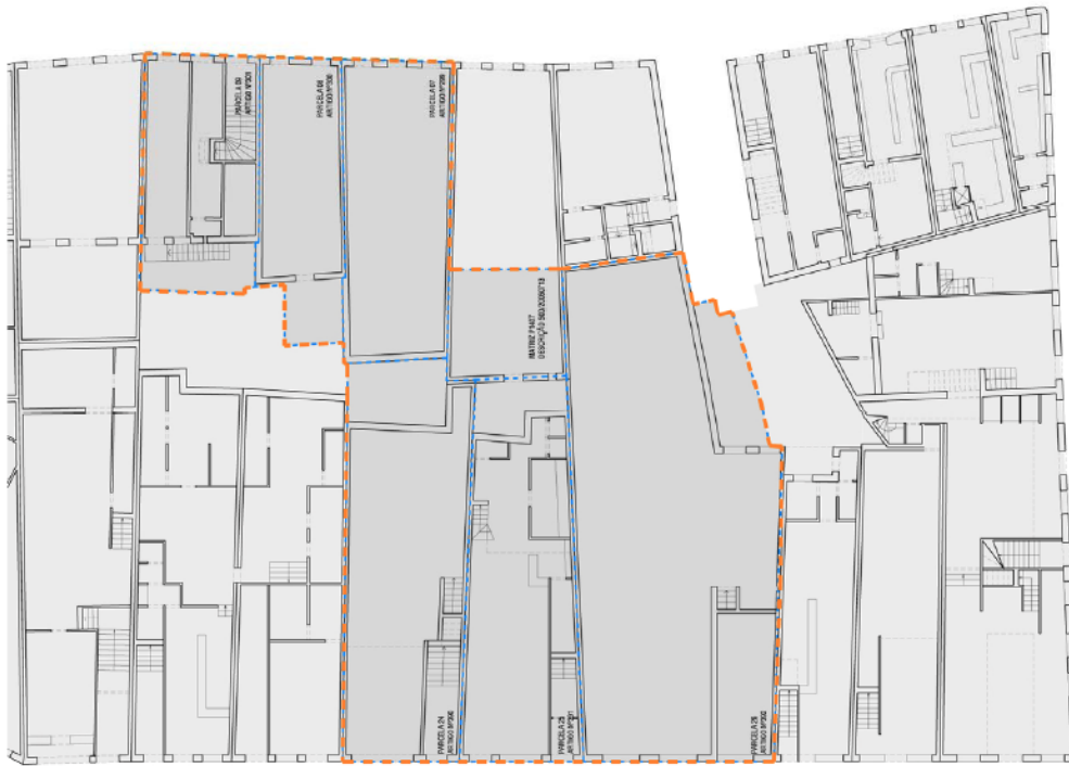
Figura 19 - Tipologia interna e parcelamento dos imóveis 7, 8, 9, 24, 25, 26 antes da intervenção (SRU, 2007)
