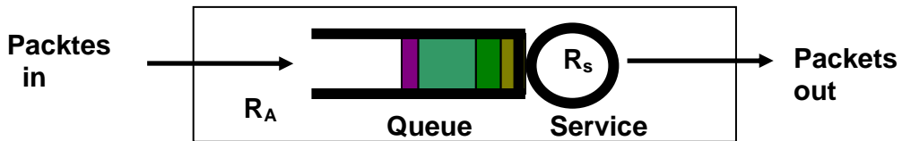
Fig. 2.3: IEEE 802.11b Buffer Queue.
