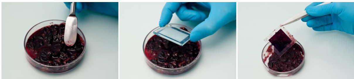
Fig. 6.4 Sensitising of TiO 2 Layer [85]
