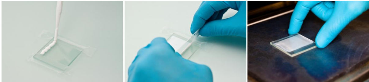
Fig. 6.3 TiO 2 Layer Preparation [85]
