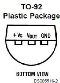
figura 9. Encapsulat i distribució de connexions del LM35
