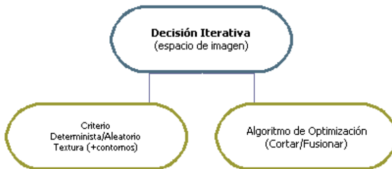
Fig.2.11.- Diagrama del Proceso Global de la Segmentación de la Imagen
