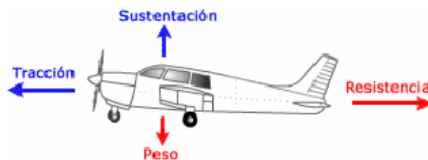
Fig. 1.5 Les 4 forces que actuen sobre una aeronau en vol
