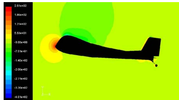
Figura 3.42 Velocitat de l'aire al voltant de l'UAV, al pla de simetria
