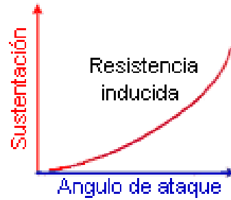
Fig. 1.12 Resistència induïda en funció de l'angle d'atac
