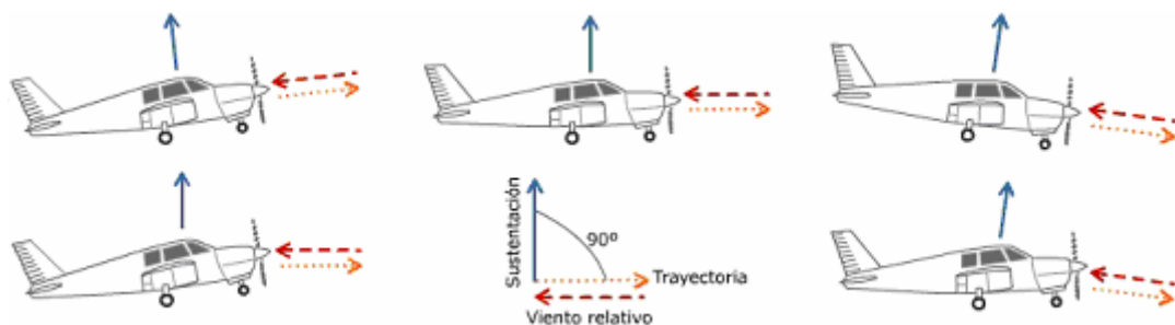
Fig. 1.9 La sustentació és sempre perpendicular al vent relatiu
