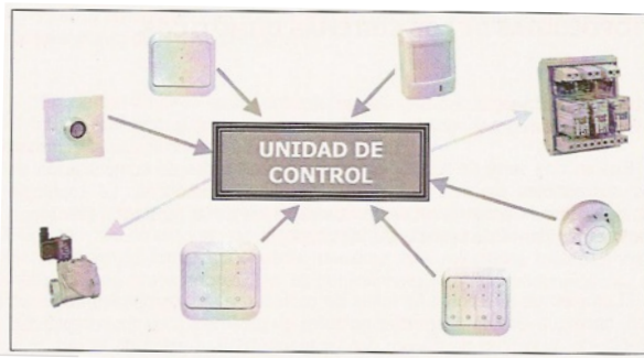
Figura 6.2. Configuración de un sistema domótico centralizado
