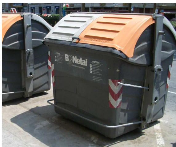
Fig. 7.9 Vista del sistema palanca muntat en un contenidor bicompartimentat.
