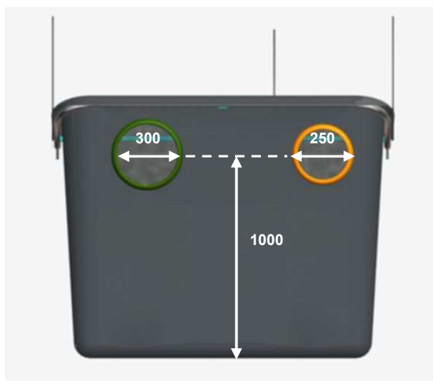
Fig. 7.12 Mida de les boques de càrrega
