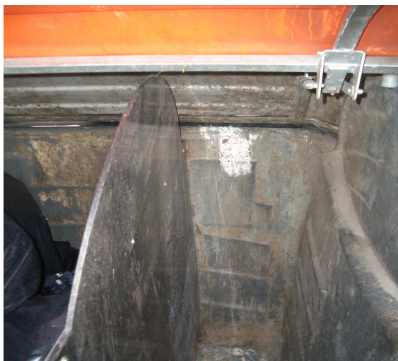
Fig. 4.3 Detall interior de la planxa separadora d'ambdues fraccions.
