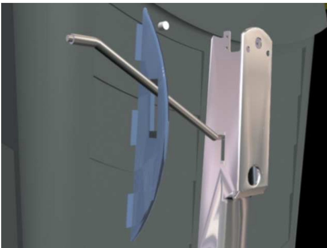
Fig. 7.30 Reforç amb forma d'arc per la palanca. S'aprecien els topalls silenciadors de cautxú, col·locats als extrems del reforç i de la caixa lateral.
