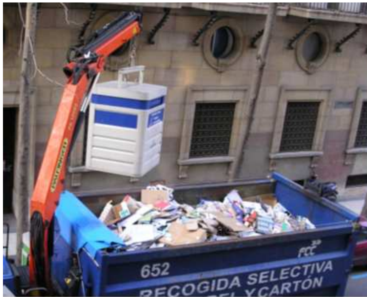
Fig. 6.13 Procés de descàrrega d'un contenidor tipus iglú.
