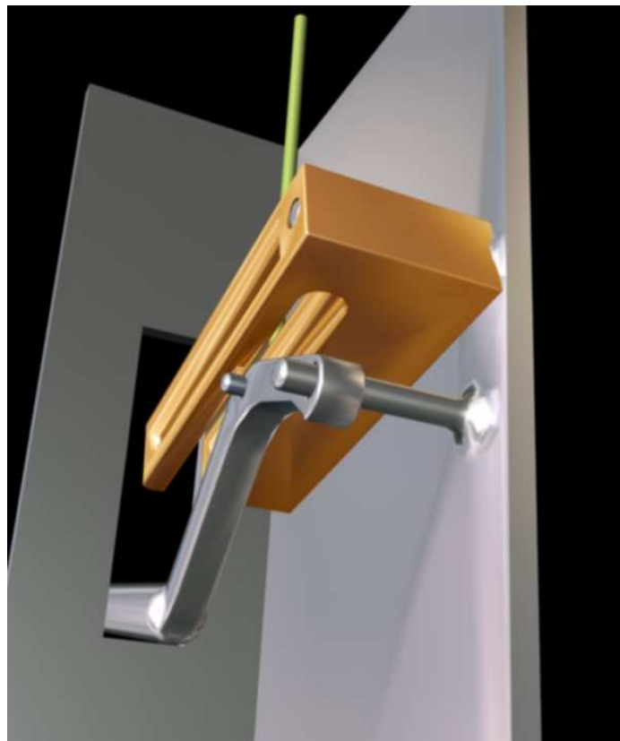
Fig. 7.29 Imatge del sistema quan està desacoblat i la palanca està lliure.
