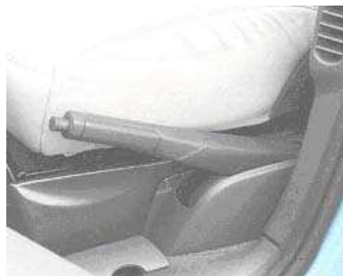
Fig. 8. Ejemplo de PKB tipo Retractable en el vehículo.
