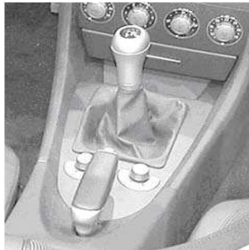
Fig. 6. Ejemplo de PKB tipo 'Z' en la consola del vehículo.
