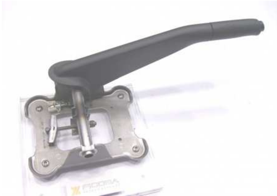
Fig. 3. Ejemplo de PKB con placa base en U.
