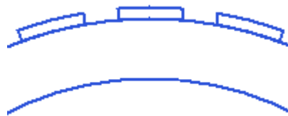
Figura 4.6 Aspecte constructiu dels imans en superfície rotòrica
