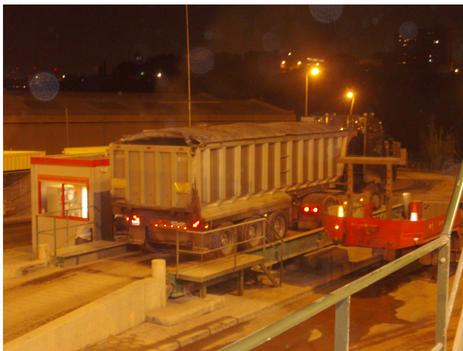
Fig. 3.12 Pesado de camión y protección con lona para proteger la mezcla.
