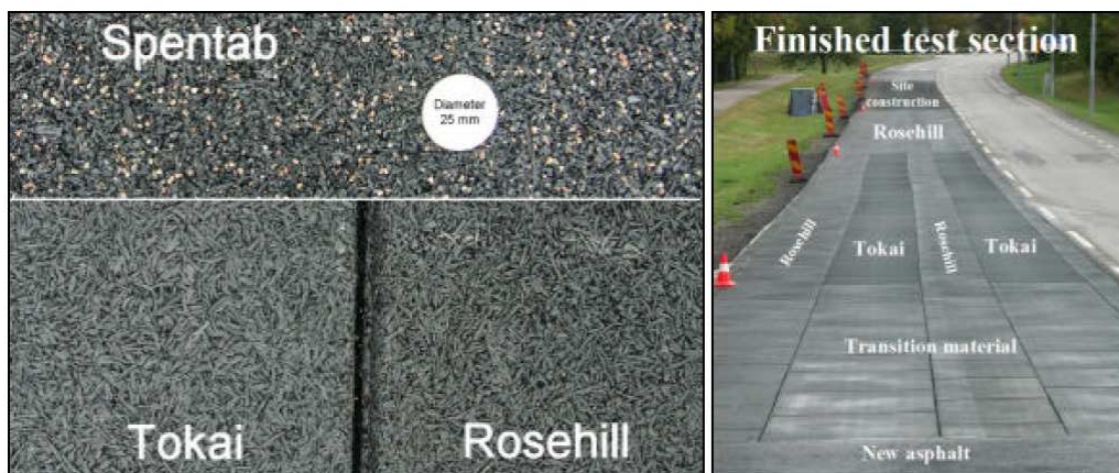
Fig. 2.14 Mezclas poro-elásticas. Fuente: Proyecto SILVIA [Ref.31].
