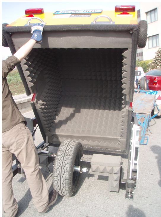
Fig. 3.24 Foto interior de la cámara semi-anechoica.
