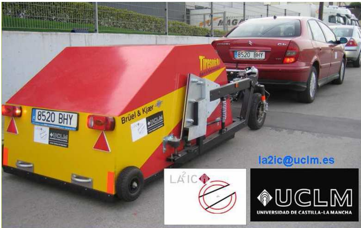
Fig. 3.23 Fotografía de vehículo y remolque de medida de ruido de rodadura para CPX Tiresonic MK4-LA 2 IC
