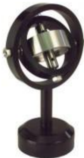
Figura 17: giroscopi mecànic captiu en un cardant
