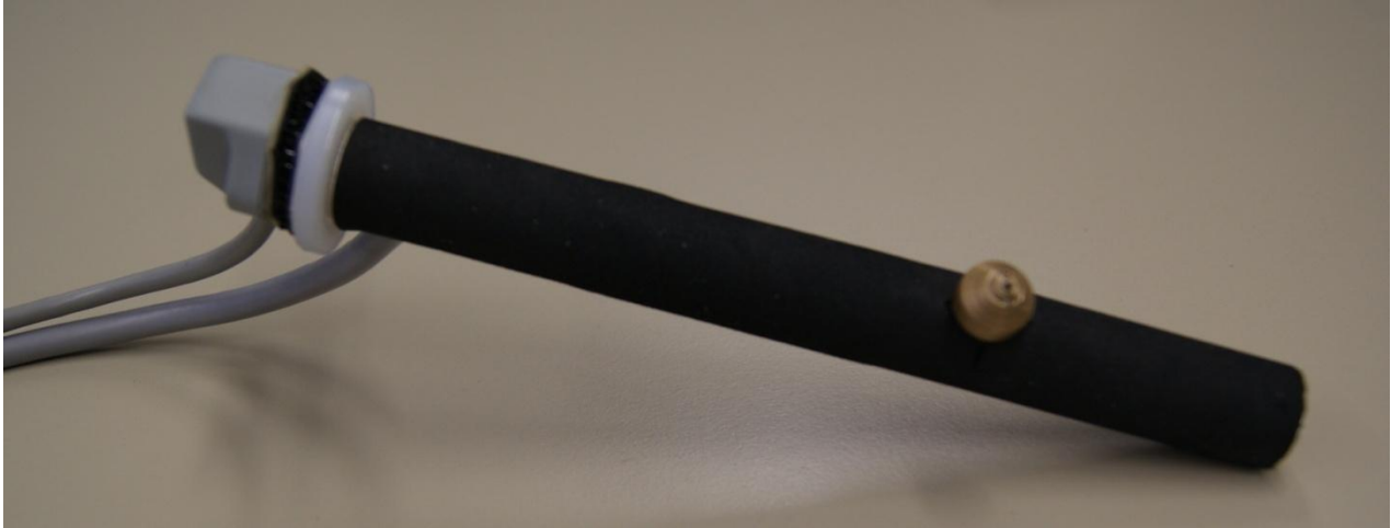
Figura 44: Mànec sensoritzat (Sensor Polhemus: part esquerra del mànec. Joystick (color daurat): part dreta del mànec)
