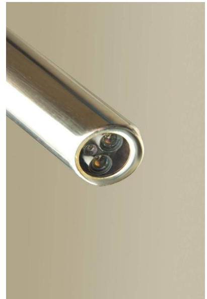
Figura 6: detector CCD a l'extrem d'un laparoscopi
