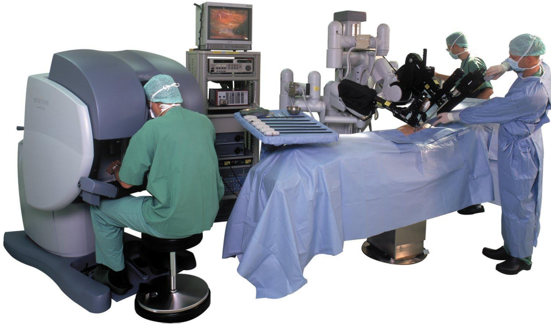
Figura 4: sistema robòtic per dur a terme cirurgies mínimament invasives amb el suport de la teleoperació Da Vinci
