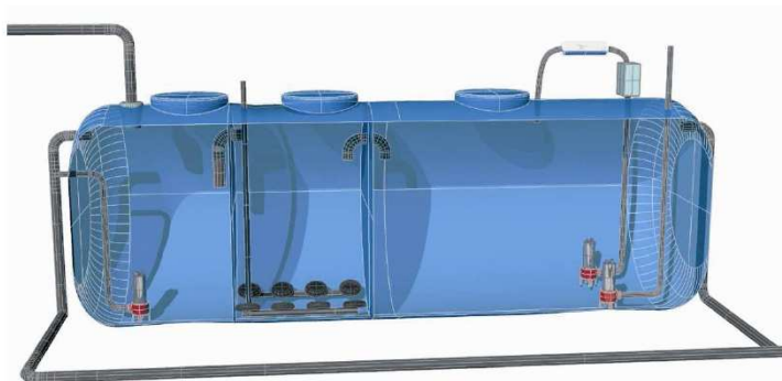
Fig. 10.3. Vista interior de las cámaras del ECOCICLE 80 – 50 [ http://www.totagua.com/ , 23 de mayo del 2010]
