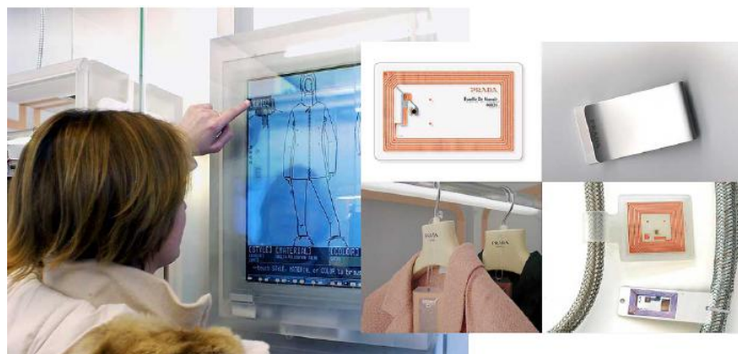
Pantalla dentro del probador y múltiples tags utilizados para etiquetar los productos
