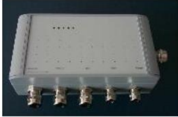
Módulo lector RFID para conectar las diferentes antenas Lector móvil RFID para PDA
