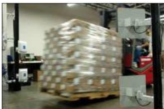
Antenas utilizadas para leer tags pasivos adheridos a un pallet
