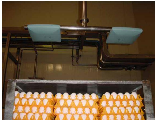
Comprobación del identificador del carro para el paso a producción
