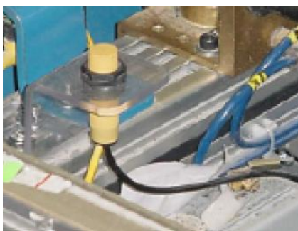
Antena entre los rodillos de la transportadora
