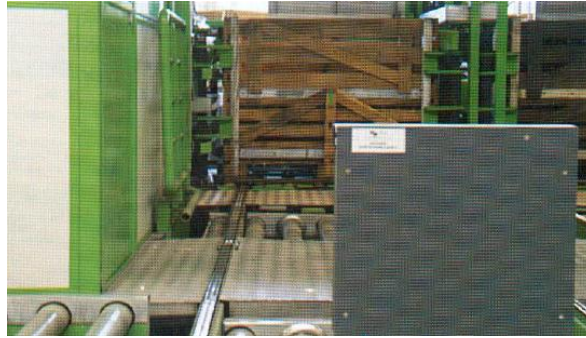
Línea de producción con el lector fijo RFID, encargado de adquirir la información del tag
