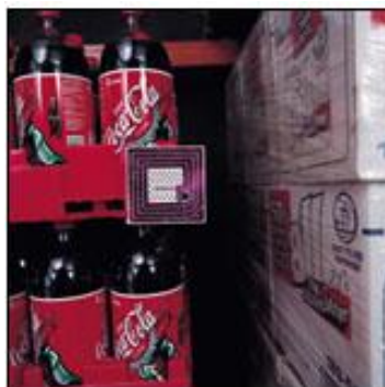
La lectura de tags en productos líquidos puede convertirse en todo un desafío
