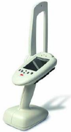
Lector móvil RFID en HF
