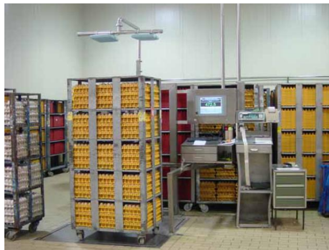
Vista de la báscula y el sistema de antenas para leer el tag del carro
