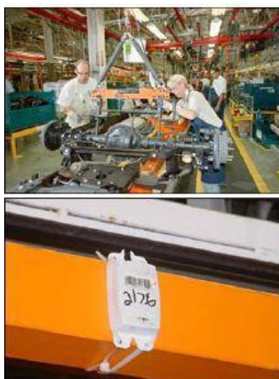
Tags activos utilizados para difundir una señal a largas distancias
