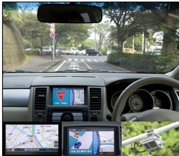
Figura 1.3 Sistema de Prevención de colisión y congestión de tráfico de vehículos (Fuente: http://www.intomobile.com/2007/04/17/nissan-developing-test-intelligent-transportation-system-mobile-phones-prevents-autopedestrian-accidents.html )
