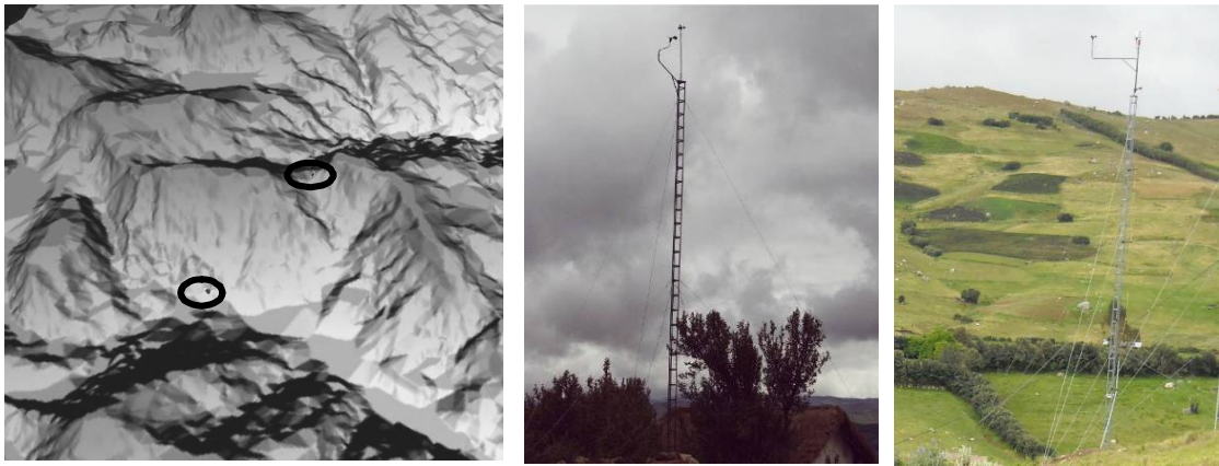
Figura 6.6 – Posición y imágenes de los anemómetros en la comunidad de El Alumbre.
