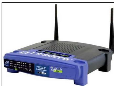
*Figura 5-1. Linksys WRT54G. Plataforma hardware inicial del proyecto OpenWRT.*
