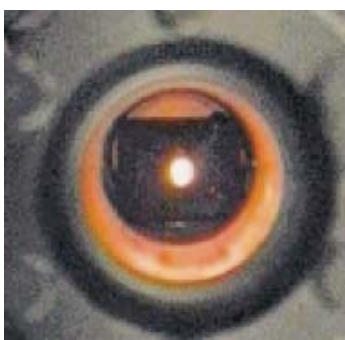
Monitorització frontal de la Llum Sincrotró emesa per un Ondulador en buit
