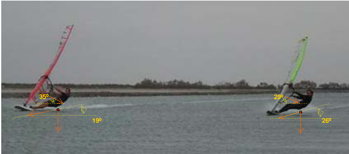
Fig. 5.10: Forces i angles de posició ( \omega i \zeta ) al PILOT.
