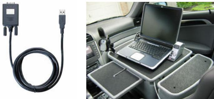
[Fig. 4.3.1.1](#) : A la izquierda un adaptador USB a serie db9. A la derecha un portátil integrado en el vehículo mediante un soporte contenedor.
