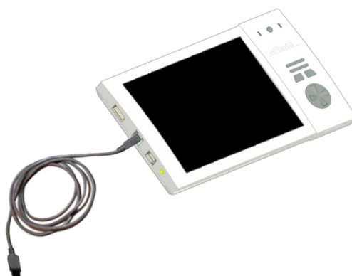
Fig. 6.4.10.1>1. Funcionamiento sin batería mediante USB.
