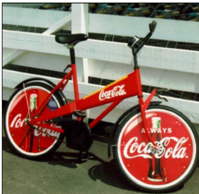
Figura 8. Bicicleta pública de segunda generación con un diseño característico que permite insertar publicidad para la autofinanciación del sistema. Fuente [9]
