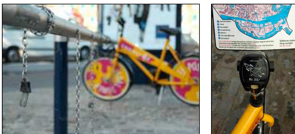
Figura 17. Cadenas del sistema de amarre de las bicicletas a las estaciones y detalle del sistema de cierre incorporado en cada bicicleta en Copenhague. Fuente: [w19]
