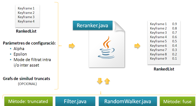
Figura 36. Esquema de classes de l'algorithm de reordenació
