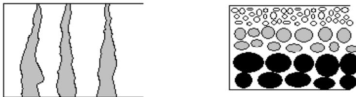
**Figura 2.8. Membrana asimétrica (o de gradiente) y membrana compuesta [modificado de Vidal-Asiain, 2005].**
