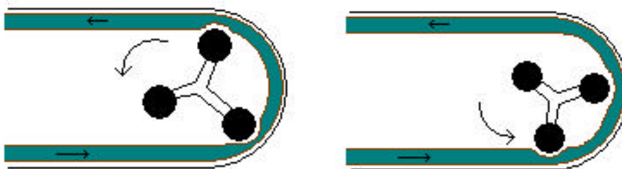
Fig. 8.14. Rotació de l'eix de la bomba on els coixinets (negres) pressionen el tub de silicona (marró per fora i blau a l'interior) amb la direcció de rotació marcada per la fletxa corba.
