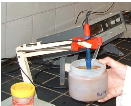
Figura 18. Determinació de pH directament de la pasta saturada.
