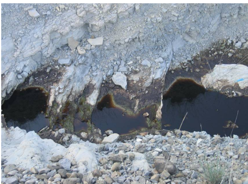
Fig. 8.3. Punto de fuga de lixiviados del vertedero. Origen del riachuelo de lixiviados
