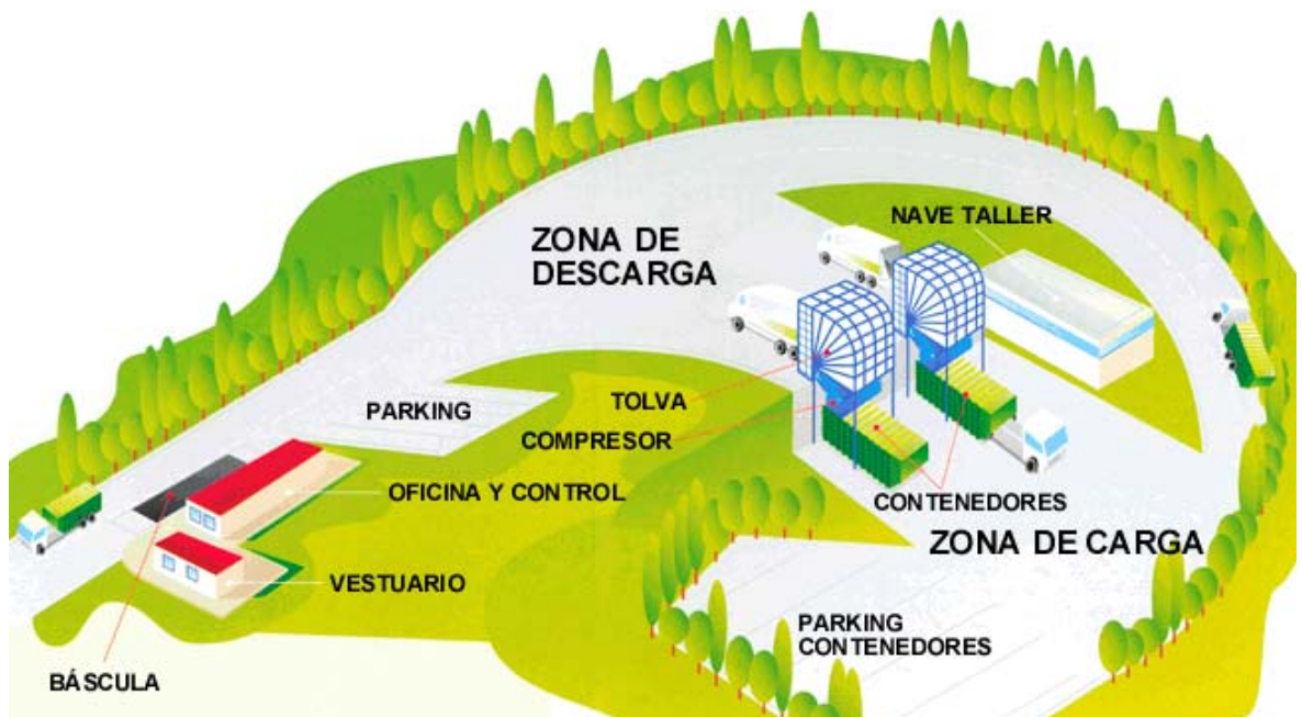
Fig. 5.1. Ejemplo de una planta de transferencia con compactación
